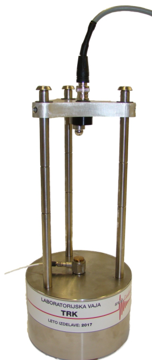
Slika 14: Slika naprave za merjenje časovnega poteka sile pri trku kroglice s podlago.
